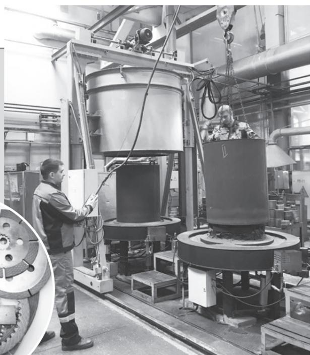
ровка, изготовление теплоизоляции свода колпака печи из волокнистых материалов, применение автоматизированной системы дожига отработанных газов с автоматическим контролем пламени.
