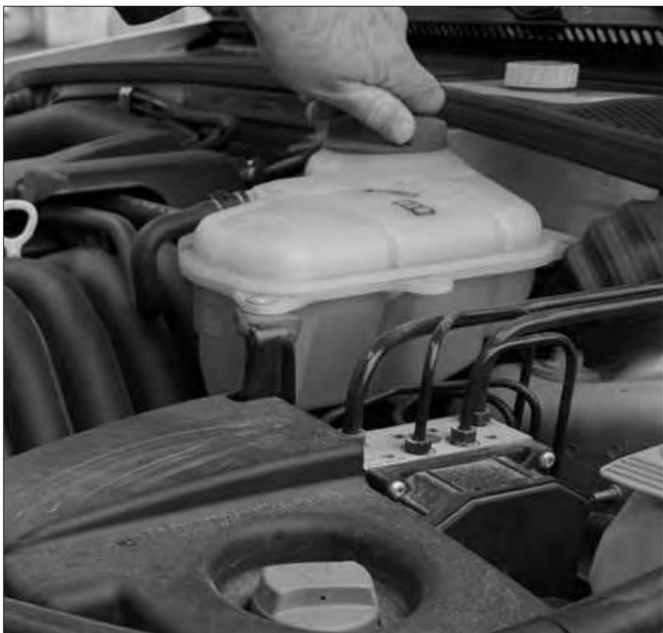
ДВИГАТЕЛЬ. Откройте пробку расширительного бочка сразу после пуска мотора (пока он ещё не прогрелся): если из охлаждающей жидкости поднимаются пузырьки, то прокладка головки блока пробита. Фото: Алякс Дастанко
